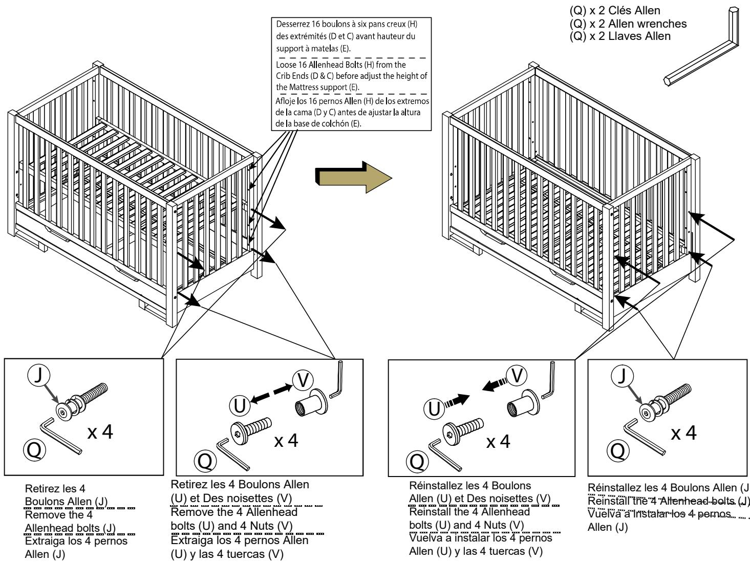
Desserrez 16 boulons à six pans creux (H) des extrémités (D et C) avant hauteur du support à matelas (E).
